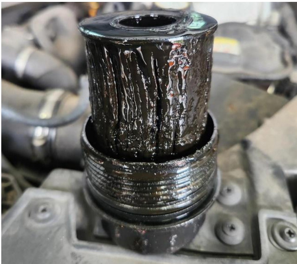
Całkowicie zatkany filtr oleju
