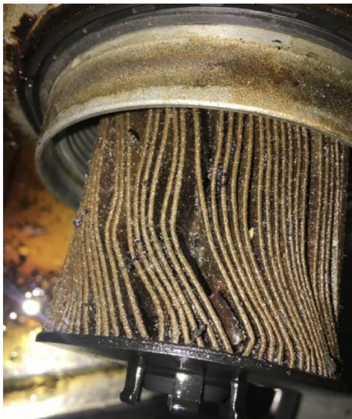
Silnie zatkany filtr oleju
